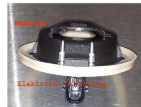
Sensor sett fra underside
