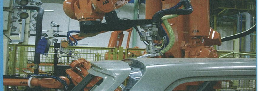
Montering / Liming av ruter
